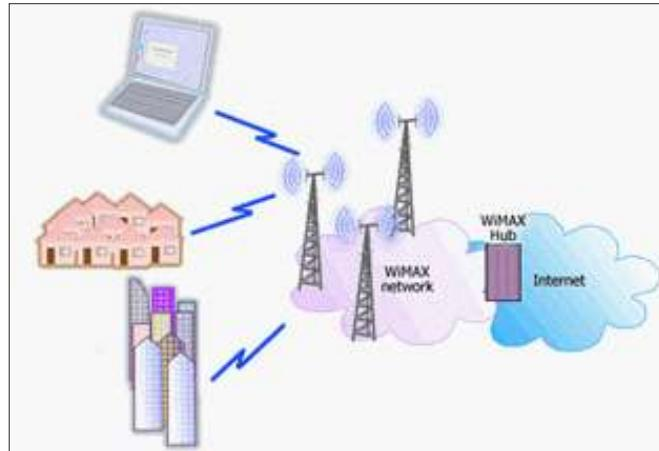
**WiMAX**, siglas de Worldwide Interoperability for Microwave Access (Interoperabilidad mundial para acceso por microondas), es una norma de transmisión de datos que utiliza las ondas de radio en las frecuencias de 2,3 a 3,5 Ghz.
