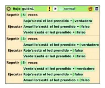
En el ejemplo se utilizaron bloques de repetición para retrasar el tiempo de prendido y apagado.
