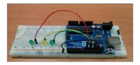
Simular la conexión en el programa Physical Etoys utilizando leds comunes, ya que sólo se van a prender y apagar. Modificar los colores de los leds con el halo **Color**
