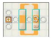
El bucle encierra de forma gráfica la acción que se desea repetir. Por ejemplo, para repetir el movimiento de un motor, se grafica de la siguiente forma:
