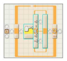
4. En el bloque **Bifurcación** se encuentra por defecto seleccionado el sensor de toque. Como en este caso el control se realiza por el sensor de sonido debe ser modificado en la configuración. Al cambiar el sensor, cambian el ícono y los parámetros.
