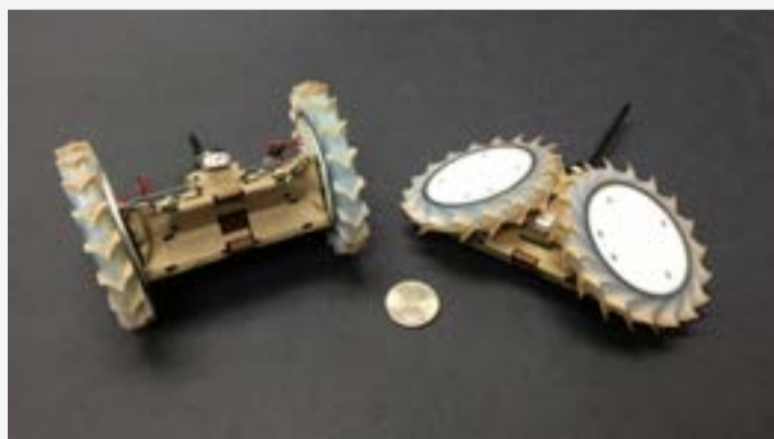
MiniRobot para ductos o trayectos riesgosos.
