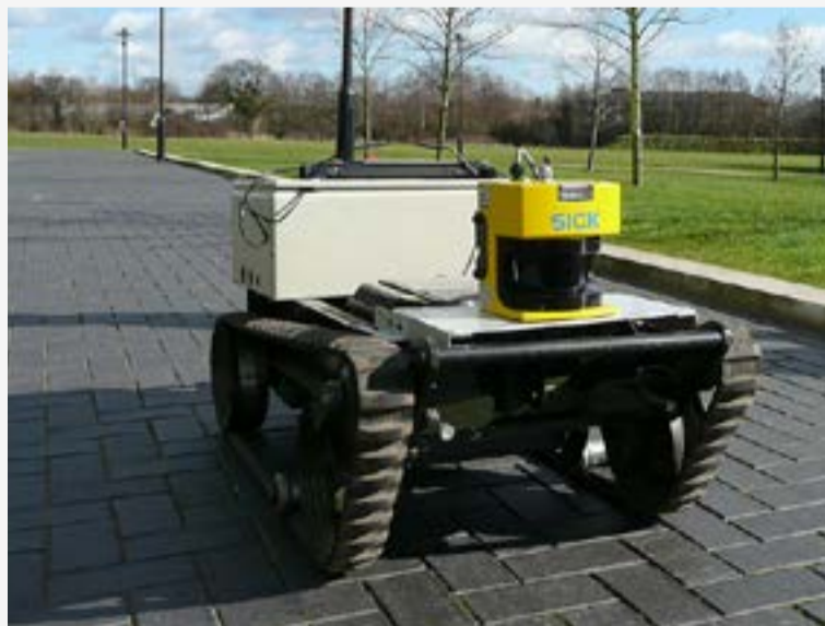
Robot móvil con sensor LIDAR.
