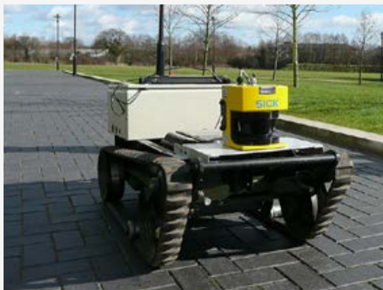
Robot móvil con sensor LIDAR.
