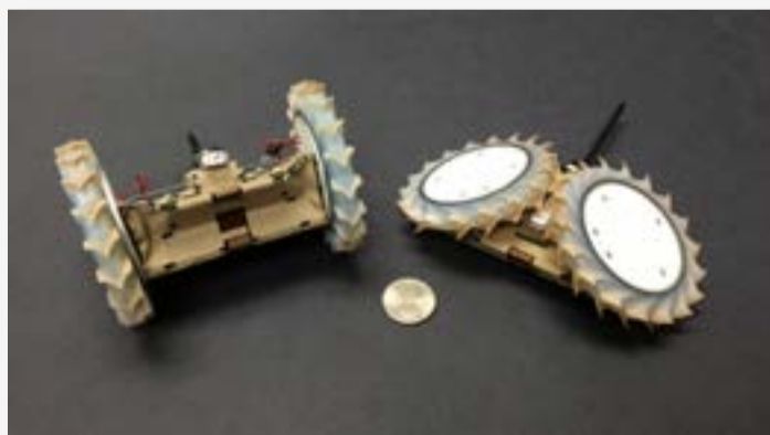
MiniRobot para ductos o trayectos riesgosos.
