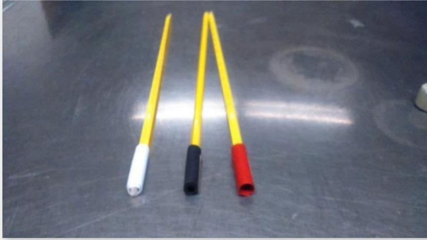
Figura A. Termómetros forrados con papel de distinto color.
