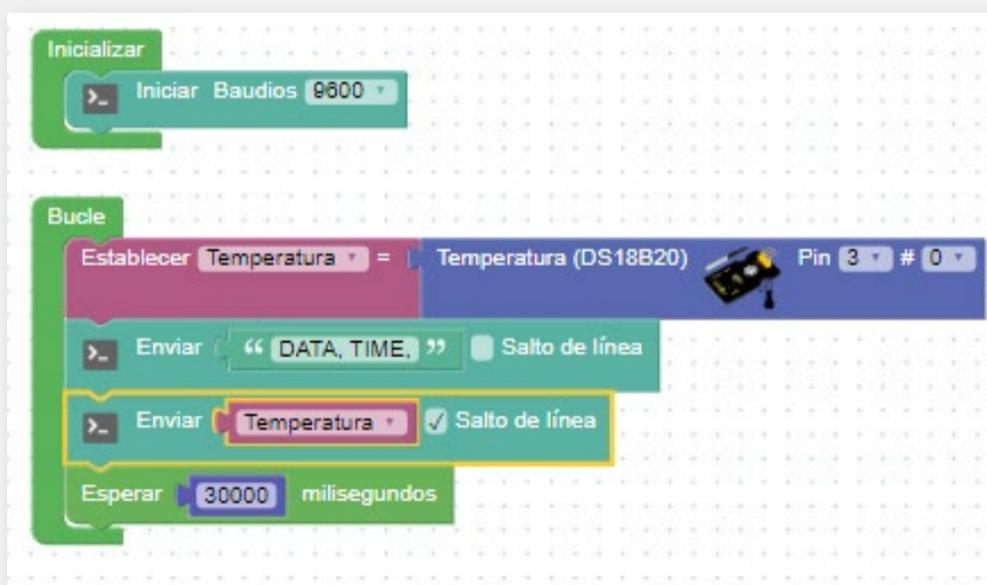
Pueden modificar el tiempo de espera de la programación en función del intervalo deseado (la captura muestra una medición cada 30 segundos).
