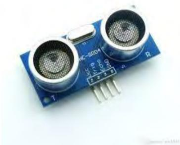
El módulo ultrasónico HC-SR04 tiene 4 pines, tierra, VCC, trigger y eco. Los pines de tierra y VCC del módulo deben conectarse a los pines de tierra y de 5 voltios en la placa Arduino, respectivamente, y los pines trigger y de eco a cualquier pin de I / O digital en la placa Arduino.
