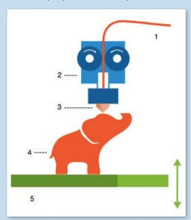
El material se calienta y se va depositando mediante una boquilla que se desplaza.
