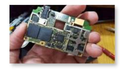
Microcontrolador de una placa de un teléfono móvil.
