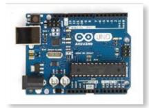
Microcontrolador de una placa Arduino Uno.
