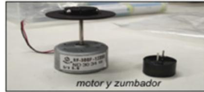
¿Poseen estos elementos dos zonas para conectar los cables al igual que la lamparita? ¿Se podrá armar un circuito eléctrico con una lamparita conectada a un motor o un zumbador? Pongan a prueba sus ideas y dibujen un esquema de cómo conectaron los elementos en los circuitos.
