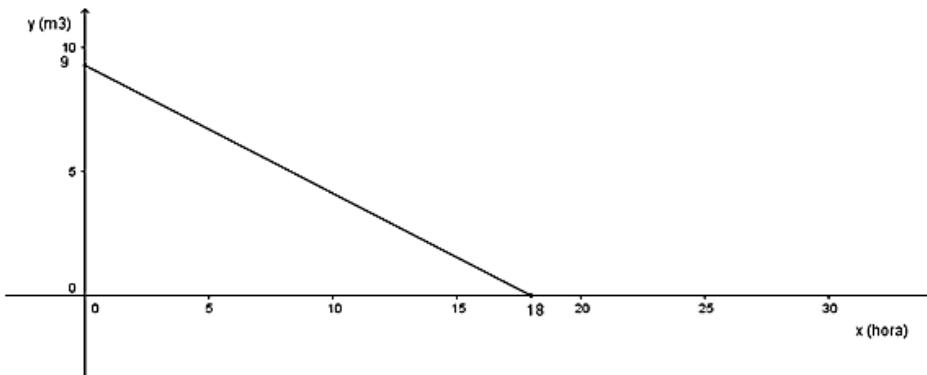
c) Intersección con el eje  $x$ :  $P=(0; 18)$ , es decir que la bomba debe funcionar 18 hs para vaciar la pileta
