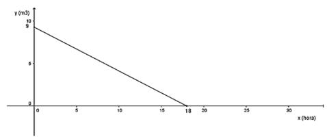
c) Intersección con el eje x: P=(0; 18), es decir que la bomba debe funcionar 18 hs para vaciar la pileta
