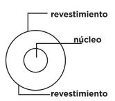
Su funcionamiento se basa en transmitir por el núcleo de la fibra un haz de luz, tal que este no atraviese el revestimiento, sino que se refleje y se siga propagando sin pérdidas de energía.
