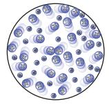
En el caso del plasma, el cambio físico no es evidente a simple vista. Aquí los átomos se mueven desordenados (igual que en el gas) pero gran parte de sus partículas están cargadas electricamente. Algunos de los electrones se separaron del átomo y se mueven libremente. Quedan IONIZADOS \*
