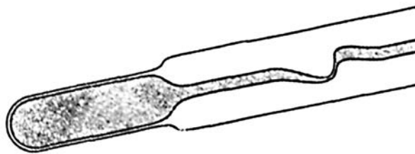
Figura 2: Estrangulamiento en un termómetro clínico
