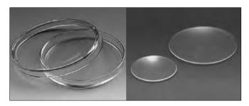
Figura 1. Placas de Petri (izq.) y vidrios de reloj (der.)
