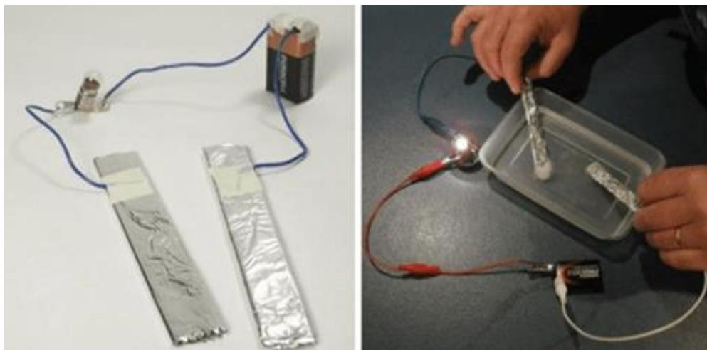
Una vez que tengan listo el dispositivo coloquen los palitos de helado con aluminio dentro del recipiente con agua y observen qué ocurre. Luego irán agregando distintas cantidades de sal al agua y registrando las observaciones en un cuadro como el que sigue:
