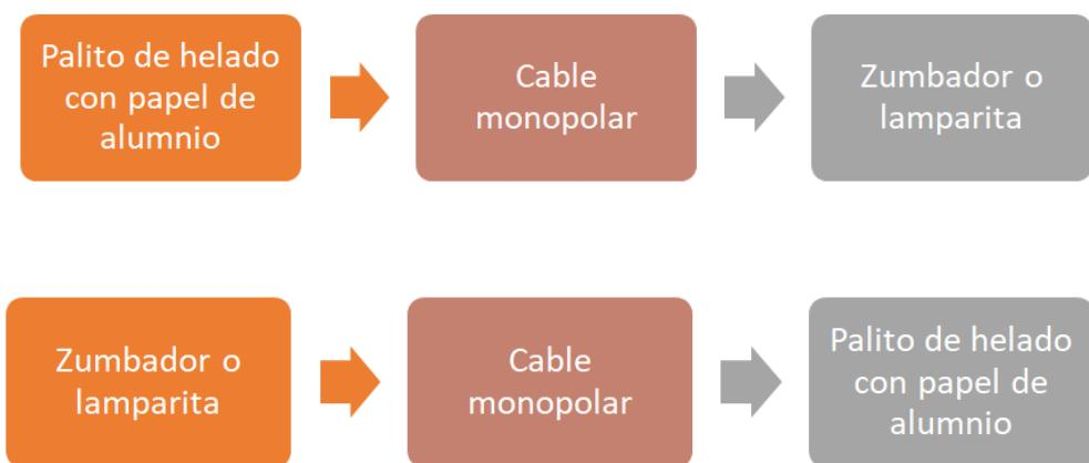
Conecten cada una de las partes de manera tal que la lamparita encienda (protejan y aseguren las conexiones con cinta aislante). Para esto tendrán que definir el lugar más conveniente para colocar la batería.
