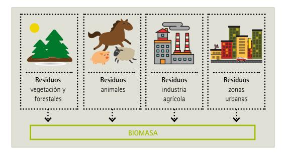
Cualquier residuo orgánico es susceptible de ser sometido a procesos de degradación anaeróbica para su aprovechamiento energético. La digestión anaeróbica es un proceso bioquímico que se realiza por la acción de diferentes bacterias y en ausencia de oxígeno, que genera como producto el biogas, que es un gas aprovechable como alternativa al gas natural.
