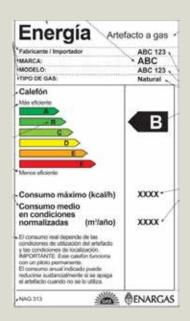
Etiqueta para aparatos de producción instantánea de agua caliente para usos sanitarios provistos de quemadores atmosféricos que utilizan combustibles gaseosos (calefones) sin piloto permanente.
