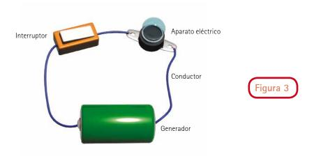
El producto de la corriente eléctrica por la diferencia de potencial (tensión) aplicada a un circuito eléctrico se denomina potencia eléctrica y su unidad es el Watt (W).
