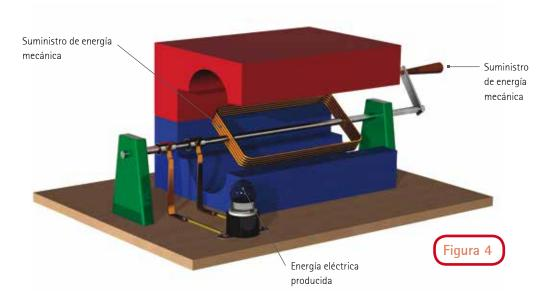
Según el tipo de desplazamiento producido, se distingue entre corriente continua, en la que los electrones se desplazan siempre en el mismo sentido (pila), y corriente alterna, en la que los electrones van cambiando su sentido de movimiento unas 50 veces por segundo, en un recorrido sinusoidal (generador eléctrico).
