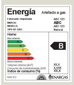
Etiqueta para aparatos de cocción a gas que poseen solo horno.
