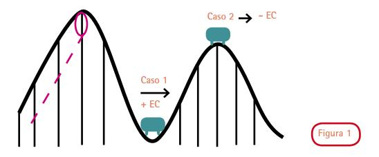
A medida que el carrito se mueve en un tramo de subida, su energía cinética disminuye y se hace cero en la parte más alta, antes de la caída, en donde está detenido por unos instantes. La energía potencial, en cambio, va aumentando a medida que el carro asciende y se hace máxima en la cúspide. A medida que el carro desciende, su velocidad aumenta y, por ende, su energía cinética, mientras que la energía potencial desciende hasta cero en la base de la montaña rusa.
