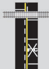
H.13 CRUCE FERROVIARIO
