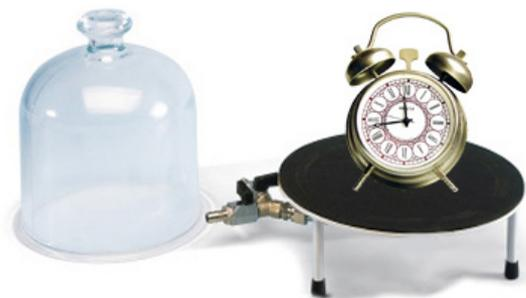
Imagine una experiencia con un viejo reloj despertador con campanilla. Se ajustan sus controles para que comience a sonar a los diez minutos. Se coloca el reloj en la base del aparato de la figura y se lo tapa con el recipiente de vidrio. A los diez minutos, puede apreciarse no solo el sonido que viene del interior de la campana, sino también la vibración de esta última. Luego se ajustan los controles del reloj para que vuelva a sonar a los diez minutos. Se repite la experiencia, pero esta vez
