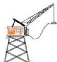
6- La imagen muestra el esquema de una grúa que utiliza un electroimán. ¿Cómo cree que debe operarse el electroimán de la grúa para atrapar y para liberar la carga?
