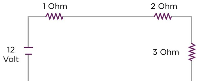
La resistencia equivalente la calculamos como:  $R_s = 1 \text{ ohm} + 2 \text{ ohm} + 3 \text{ ohm} = 6 \text{ ohm}$
