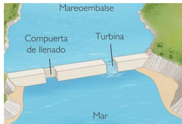
Hoy, una central mareomotriz solo resulta verdaderamente útil si la diferencia de altura entre la marea alta y la baja es de varios metros y esa condición lamentablemente se presenta en pocos lugares del mundo. La principal productora de electricidad proveniente de esta forma de energía es la central francesa ubicada en la desembocadura del río Rance, en el canal de la Mancha, en la que la diferencia en los niveles de marea llega a ser superior a los 10 metros.
