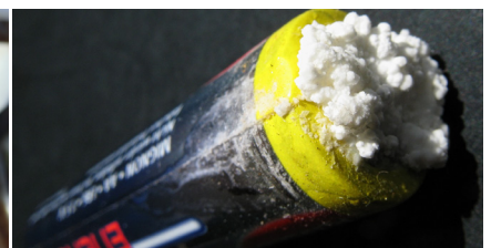
Electrolito cristalizado de una célula alcalina filtrada
